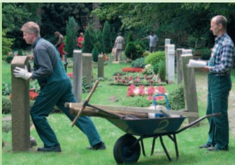
Die Aufbringung der Prüflast (von 0,3 kN) kann von Hand erfolgen
